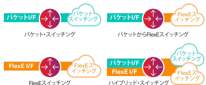
図3: パケット・スイッチングとFlexEスイッチングの例
