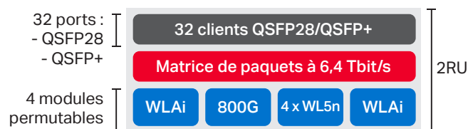
Figure 3. Architecture matérielle du 8180 de Ciena
