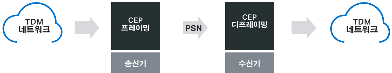
그림 3. 송신기 및 수신기 기능
