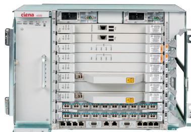
6500-S8 Packet-Optical com alimentação CC
