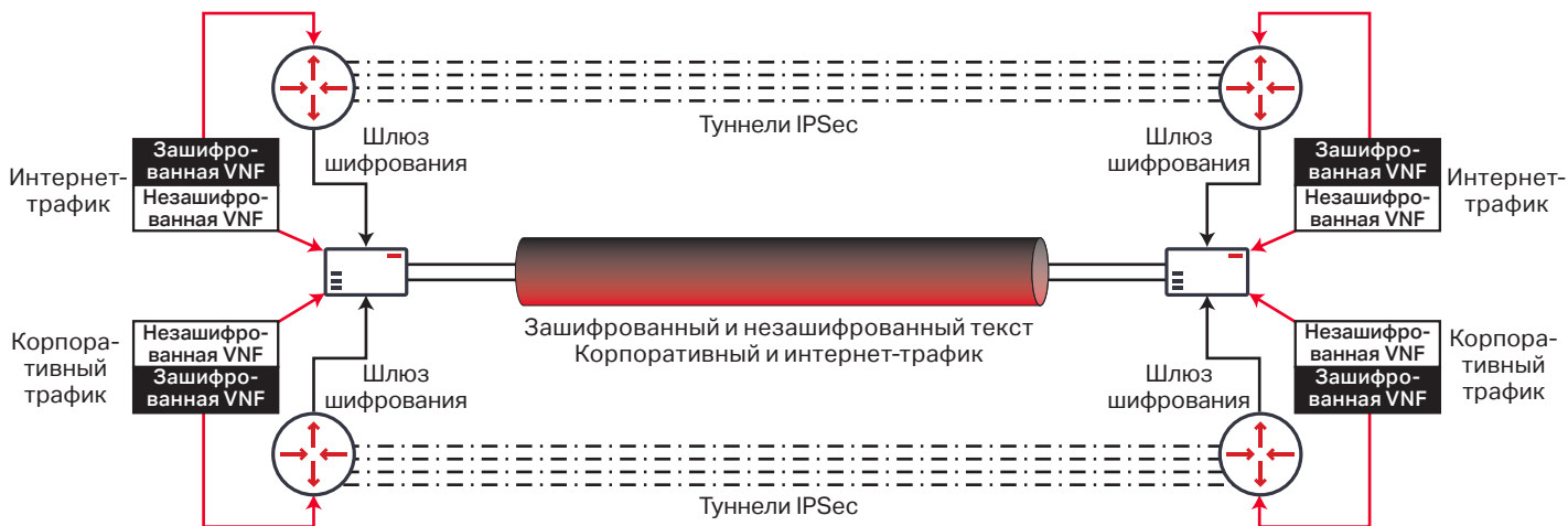
Рис. 3. Профилирование трафика для снижения стоимости шлюза шифрования (логическое представление)
