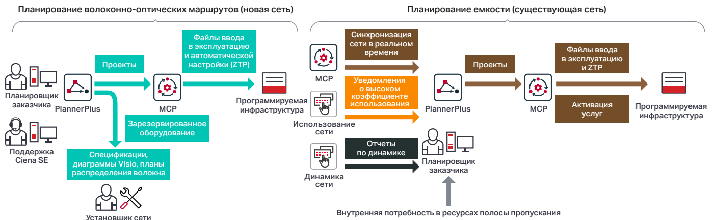
Рис. 2. Функции PlannerPlus полностью интегрированы в контроллер доменов Cienna MCP, что ускоряет развертывание оборудования и управление емкостью
