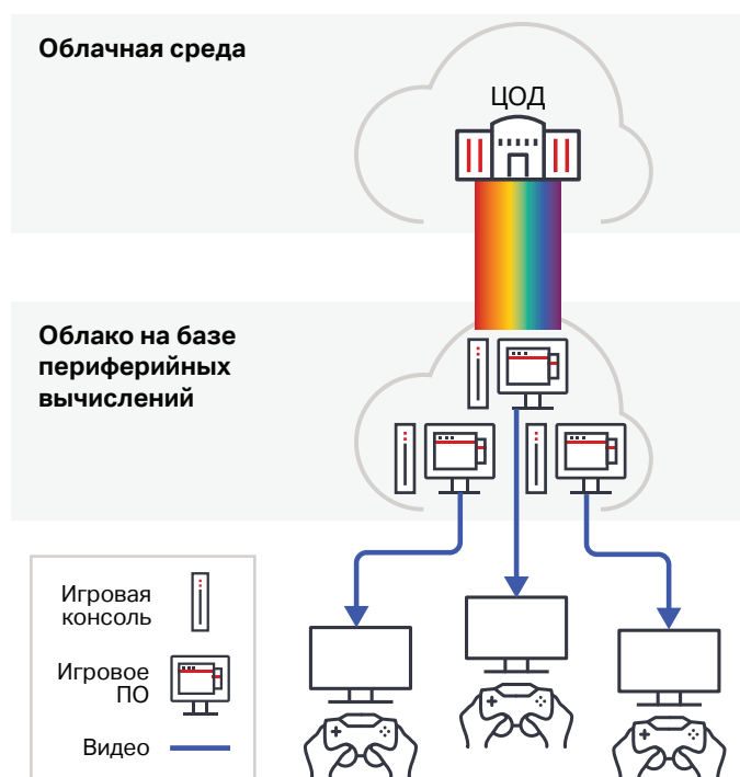
Рис. 2. Облачная игровая модель на базе периферийных вычислений
