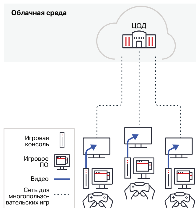
Рис. 1. Современная модель на базе игровых консолей/ПК
